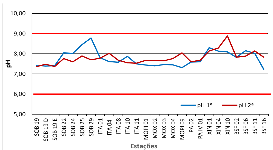
Figura 3 – Variação do pH da água de superfície nas estações de monitoramento de qualidade da água do submédio e baixo Rio São Francisco, durante as campanhas de setembro/2019. As barras vermelhas indicam os limites inferior e superior estabelecidos pela Resolução nº 357/2005 CONAMA para águas da Classe 2.
